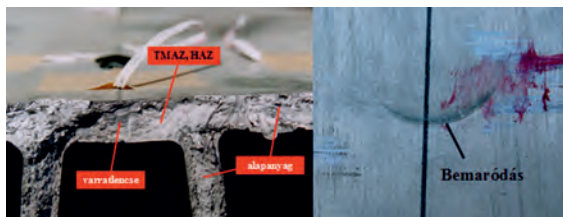
9. ábra. Törési kép és felületi varrathiba (Vigh, 2006, Vigh & Okura, 2013)
